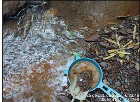
**Figura 1-141** – Coleta de amostras de sedimentos
