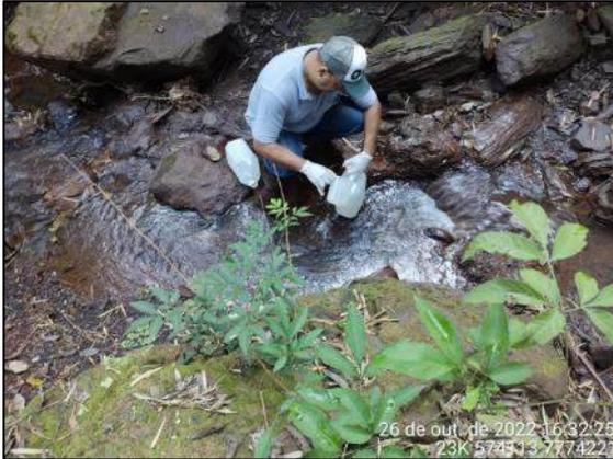
**Figura 1-140** – Coleta de amostras de água
